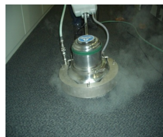
定期清掃例(カーペット)
